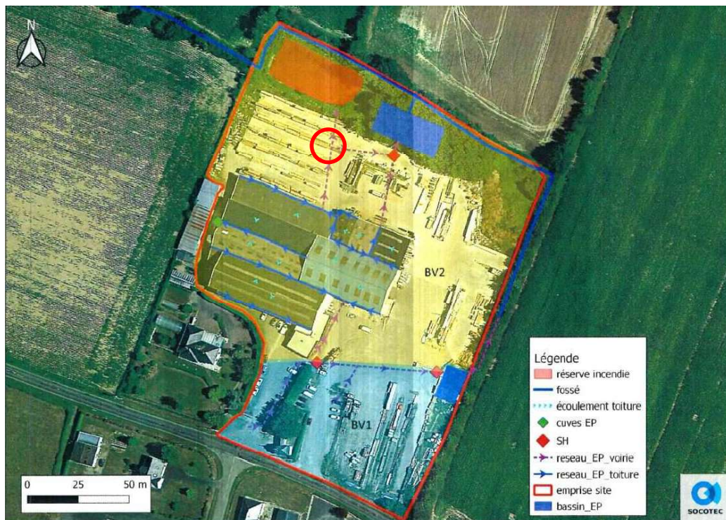
Annexe 2 : Gestion des EP après travaux de régulation-confinement (extrait de la note hydraulique du 10/08/2022)
